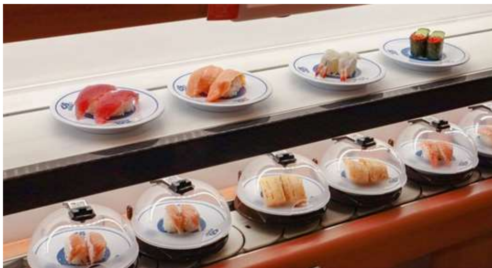
くら寿司は回転レーン（写真下段）とオーダーレーン（写真上段）を備えるハイブリット方式
